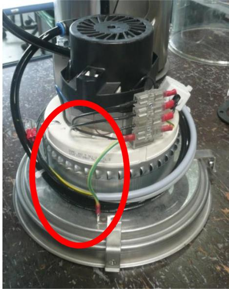
Erdungsdurchführung bei einem von zwei Typen von Gebläseaufsätzen.
