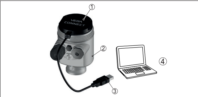
Res. 35: VEGACONNECT ve USB yoluyla bilgisayar bağlantısı
