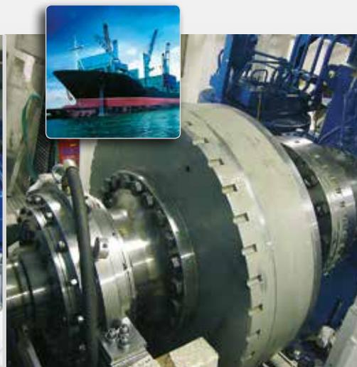
Maschinen-, Getriebe- und Propellerwellen werden mit dem Easy-Laser® System ausgerichtet. Dank der flexiblen Halterungen können Sie die Ausrüstung am geeignetsten Ort installieren: an der Welle, der Kupplung oder am Schwungrad.
