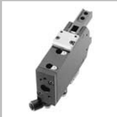
Die **Winkelgreifer GW-180** arbeiten pneumatisch **doppeltwirkend** und werden zum **Aussenspannen** verwendet. Die spezielle Formgebung der Backen-Antriebskulisse erzeugt in geschlossener Greiferstellung sehr hohe Spannkraften ohne Selbsthemmungseffekt.
